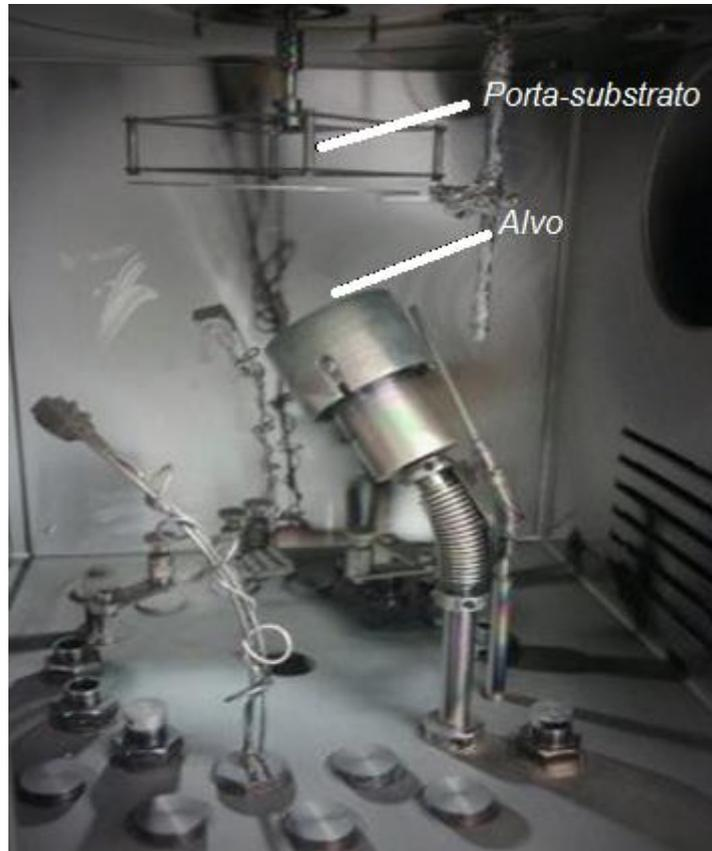
**Figura 9.** Câmara de deposição.
