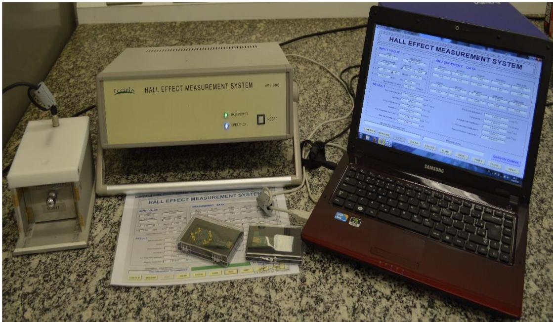
**Figura 12.** Sistema de medidas de Efeito Hall fabricado pela ECOPIA, modelo: HMS-3000.
