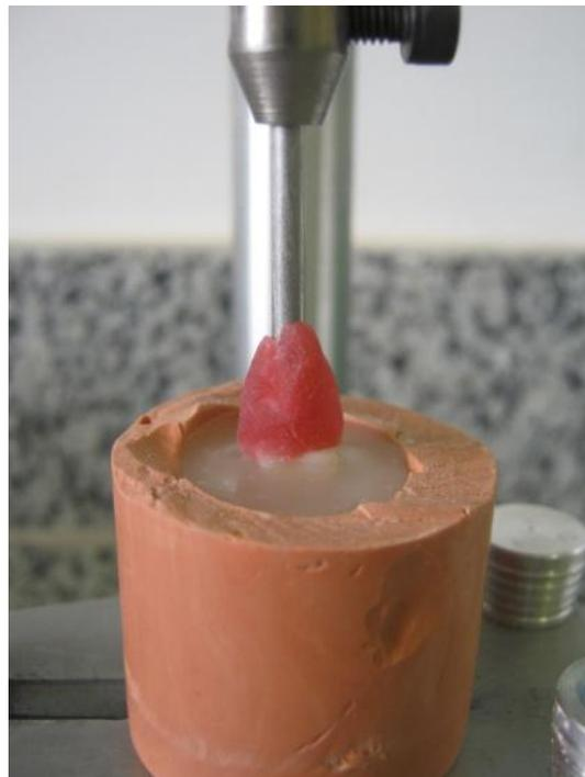
Figura 4: Conjunto cerâmica-cimento-resina incluído em resina acrílica.
