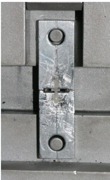
Figura 7: Espécime colado ao dispositivo do ensaio de microtração.
