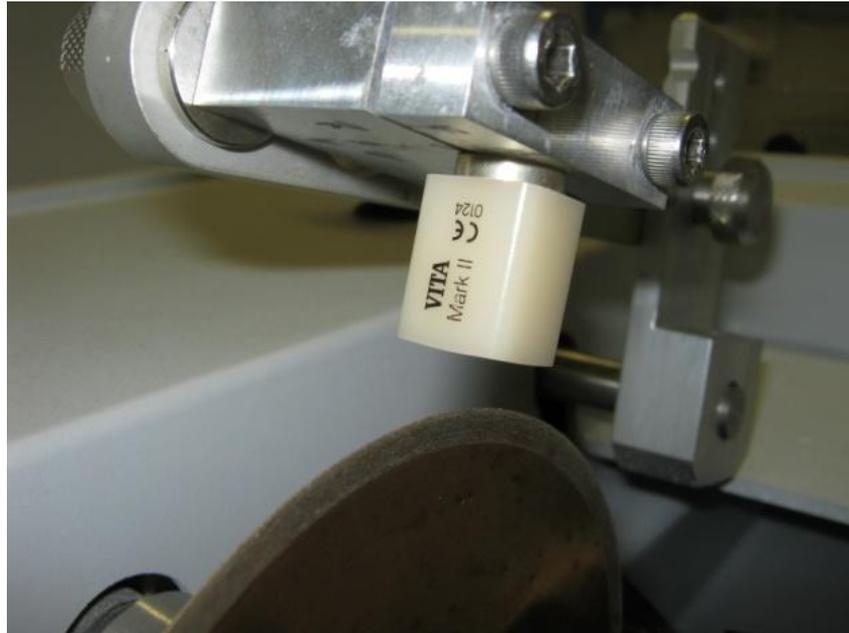
Figura 1: Bloco de cerâmica posicionado na máquina de corte.
