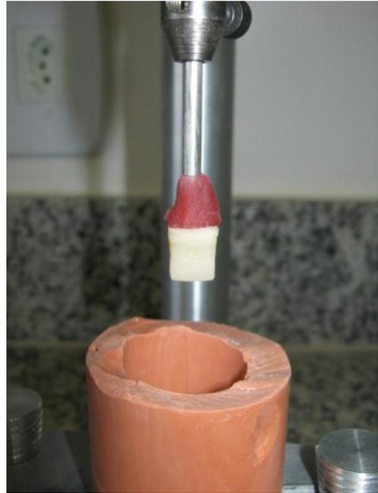
Figura 3: Conjunto cerâmica-cimento-resina antes da inclusão em resina acrílica.
