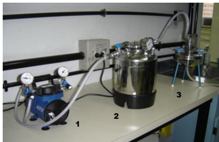
**Figura 9:** Sistema de filtração Millipore<sup>®</sup>. 1 - Bomba de vácuo com manômetros; 2 - Recipiente de pressão; 3 - Suporte de membranas.
