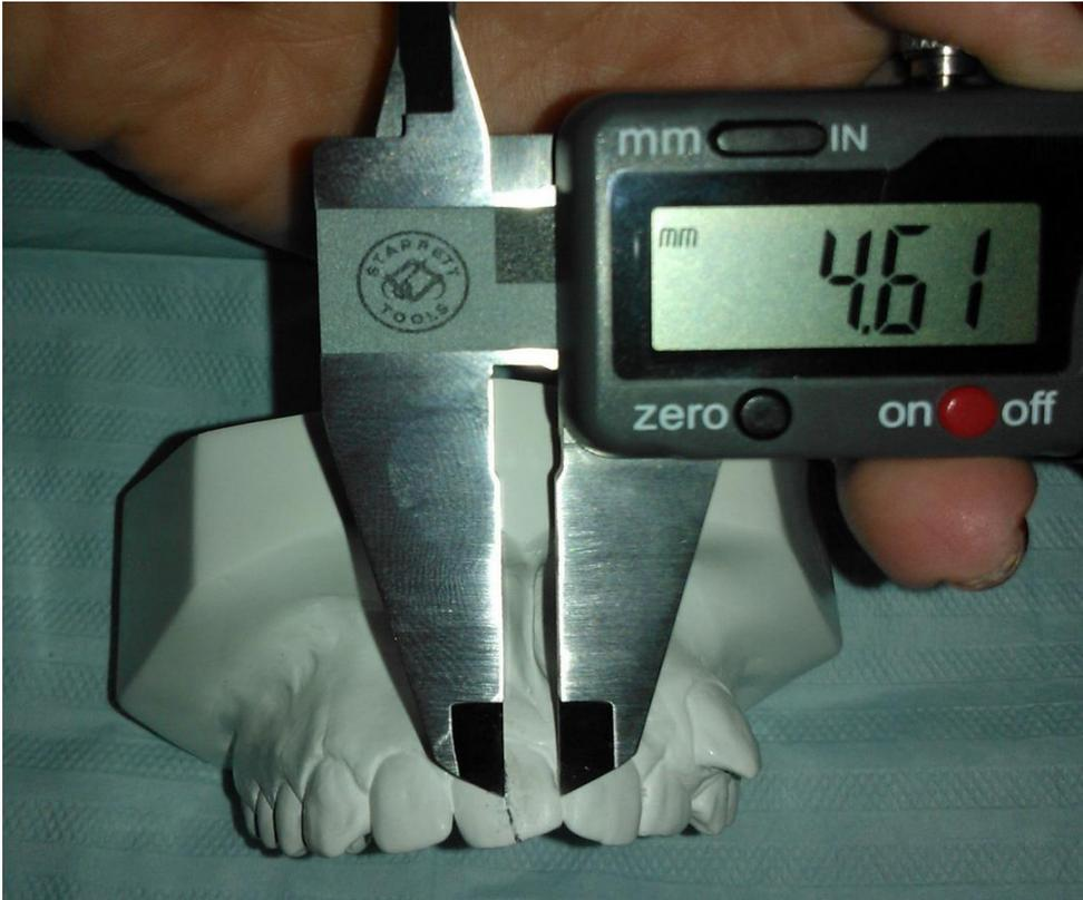
Figura 2. Demonstração da utilização do paquímetro digital
