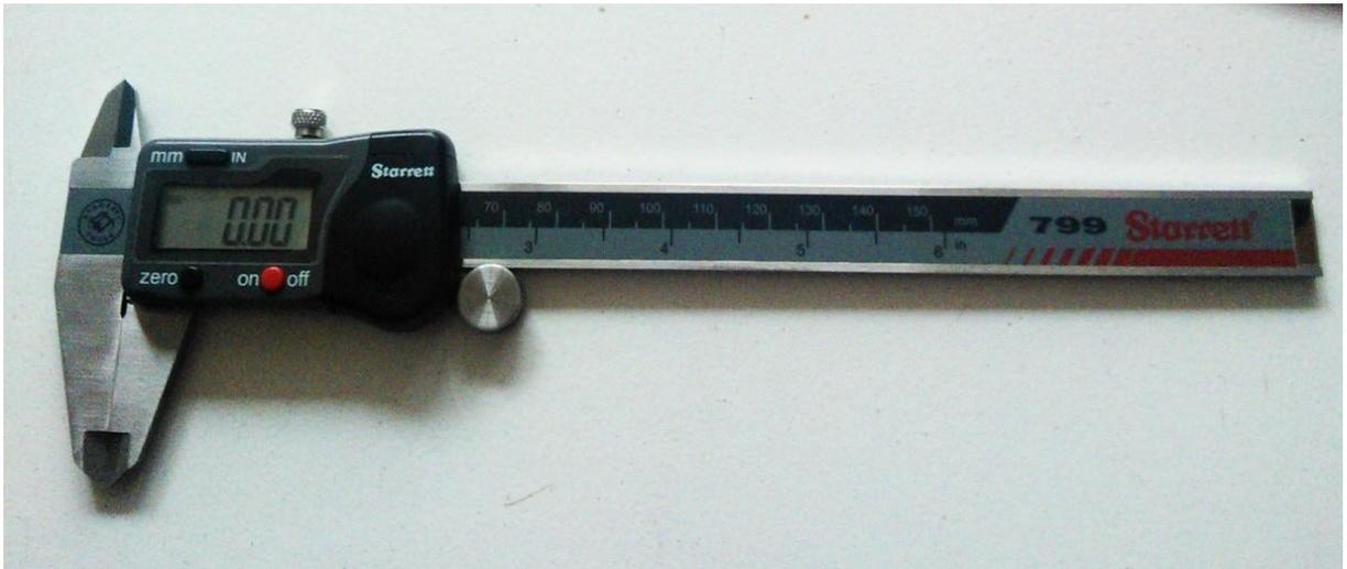
Figura 1. Paquímetro Digital Starrett série 799
