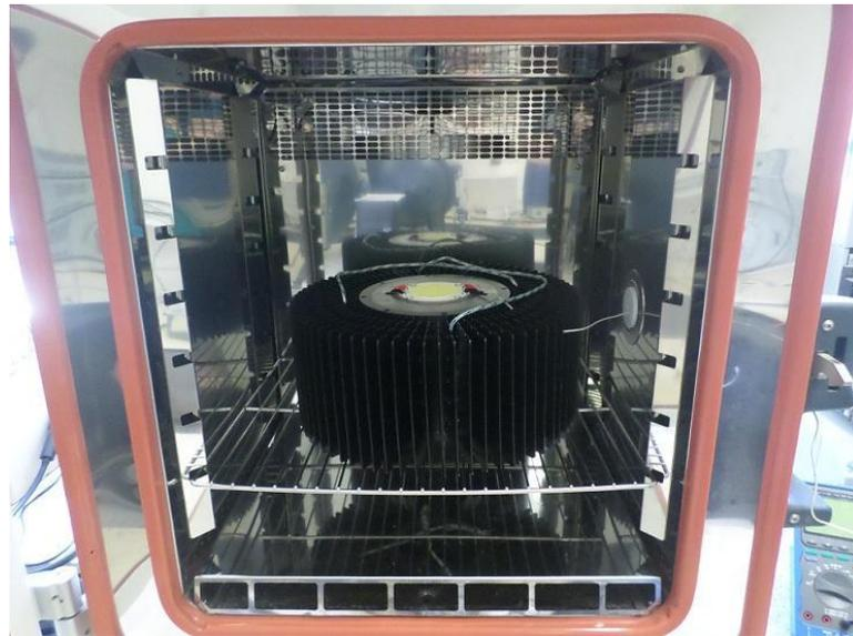
Fig. 3.6. Imagem real do EHC COB LED Apollo 600 dentro da câmara climática WEISS WKL-100 para a caracterização eletrotérmica.
