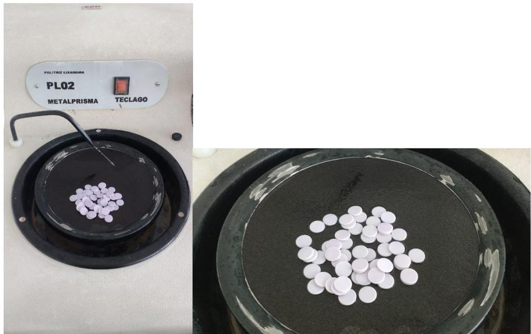
Figura 3 –Lixamento dos discos de Emax na Politriz Lixadeira PL02 - Metalprisma
