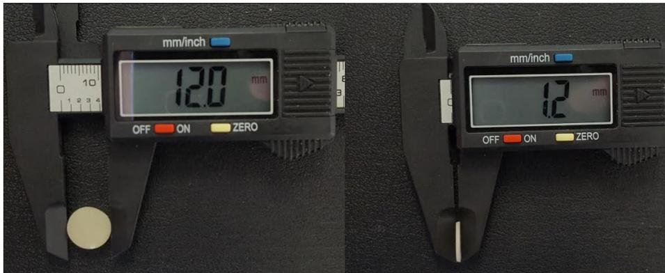
Figura 5 – Espessura e diâmetro do disco
