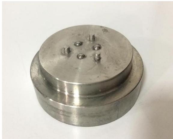
Figura 9 – Dispositivo metálico para fixação das amostras no equipamento
