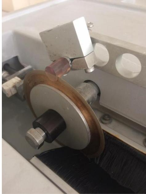
Figura 2 - Bloco arredondado de Suprinity em processo de corte
