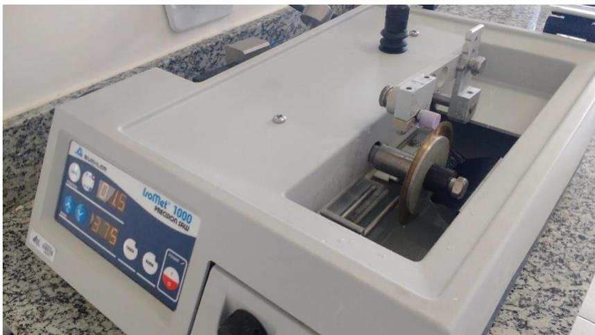
Figura 1 – ISOMET 1000 com Bloco E.max em corte
