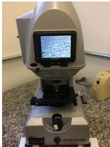
Figura 11 – Perfilômetro óptico digital com amostra posicionada (LAS-INPE)
