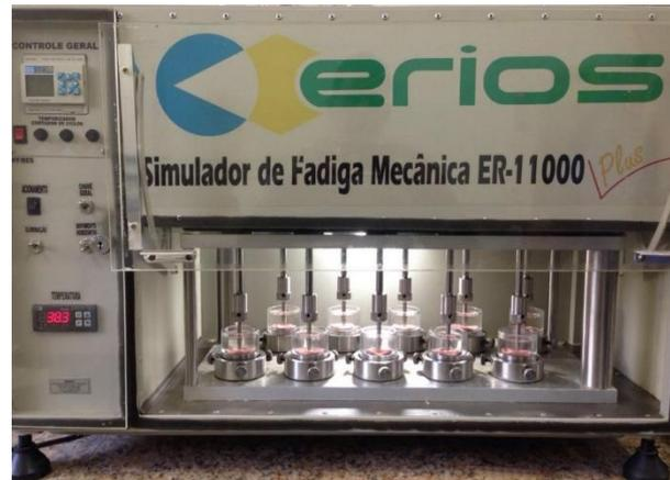
Figura 8 - ERIOS, Modelo: ER-11000 - Simulador de fadiga
