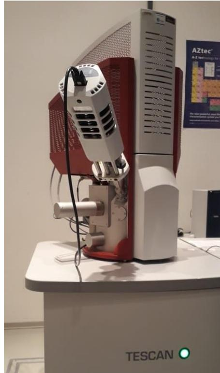
Figura 13 - Microscópio eletrônico de varredura
