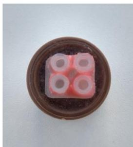
Figura 05 – Amostra com os Tygons fixados para confecção dos cilindros
