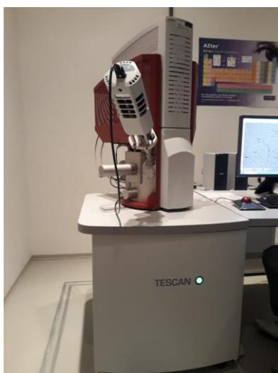
Figura 10 - Microscópio eletrônico de varredura (MEV-FEG) (LAS-INPE)
