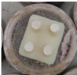
Figura 06 – Cilindros de cimento resinoso sobre a superfície cerâmica
