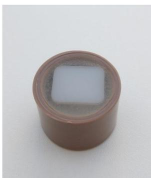
Figura 03 – Amostra incluída em resina acrílica
