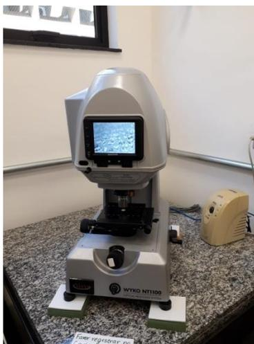
Figura 09 – Perfilômetro óptico digital (LAS-INPE)
