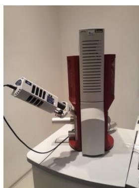
Figura 12 – Espectrômetro por Energia Dispersiva de Raios X (EDS) acoplado ao MEV (LAS-INPE)
