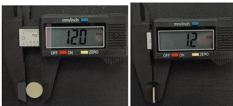
Figura 01 – Dimensões das pastilhas
