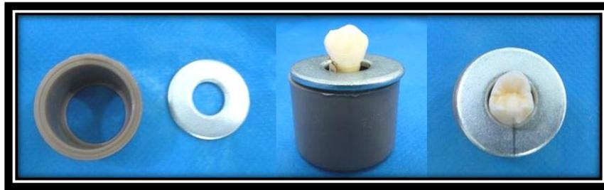
Figura 1 – Conexão de PVC e arruela metálica, utilizados na confecção da base e posicionamento do dente.
