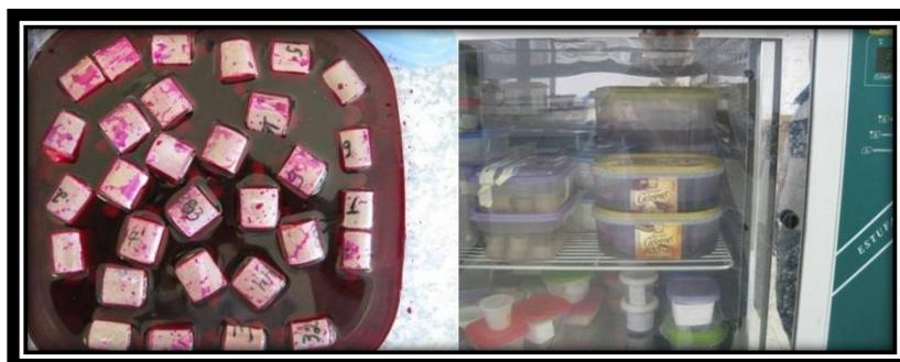
Figura 10 – Amostras imersas em Rodamina B 0,5% e armazenamento em estufa à 37<sup>0</sup>C durante 07 dias.
