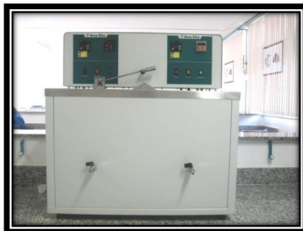
Figura 8 – Termocicladora utilizada no estudo, no laboratório da F.O. da UFJF.
