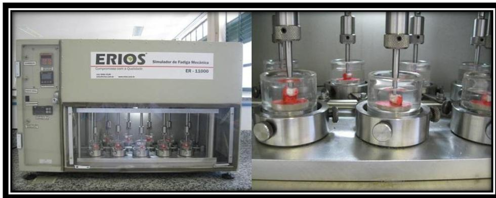
Figura 9 – Amostras na Máquina de Fadiga Mecânica (ERIOS<sup>®</sup>) sofrendo ação de forças verticais.
