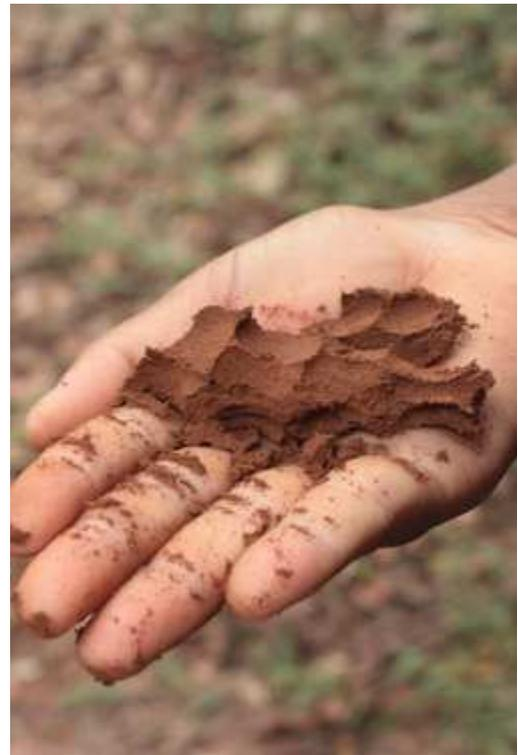
Figura 61: Barro vermelho utilizado na vedação das casas, após apertado nas mãos para verificar o ponto.
