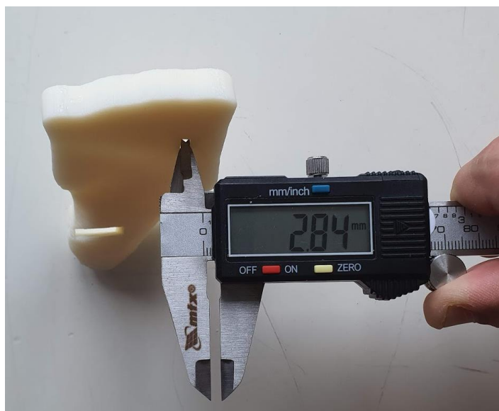
Figura 10: Foto da medição das fendas com paquímetro digital. Neste exemplo a fenda da coluna posterior foi medida na sua extremidade superior e na face abdominal do guia.
