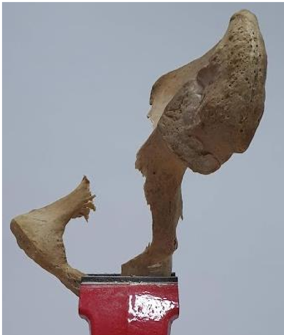
Figura 17: Foto do osso da pelve com fragmento acetabular removido. Nota-se a integridade da coluna posterior e uma fratura incompleta do ramo isquiopúbico ao redor do ponto de fixação ao torno da bancada.
