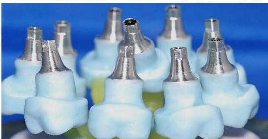
Figura 2 A – Inclusão de cera e resultado da sobre fundição/fundição.
