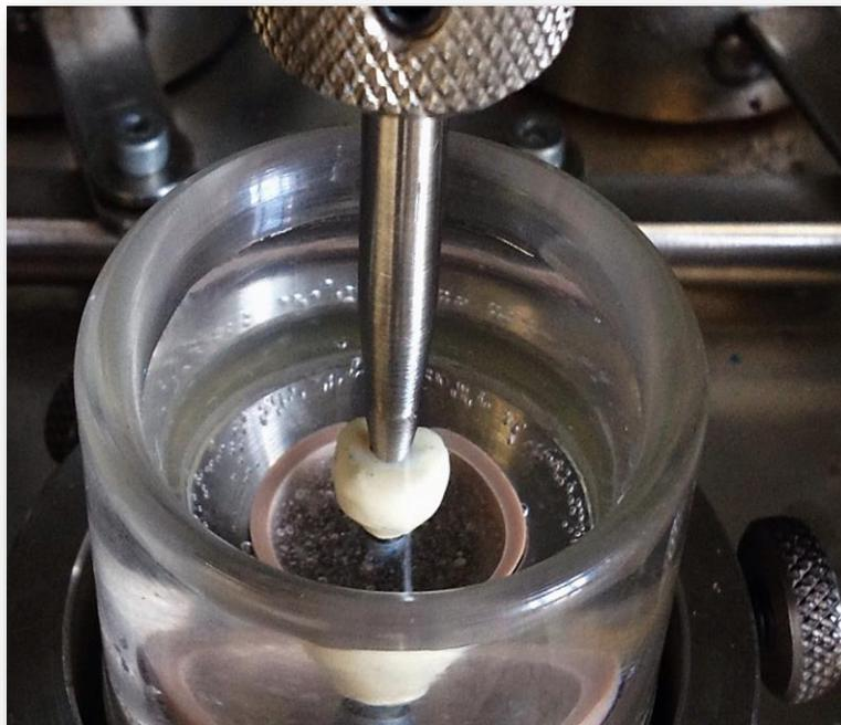
Figura 10- Inserção das amostras e os cilindros de prova na máquina de Fadiga Mecânica ERIOS 11000. Submersão em água destilada a 37°C. Total de 500.000 ciclos a 120 N/cm<sup>2</sup>.
