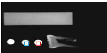
Figura 9 : Corte para análise com quadrado simbolizando o ROI. O ROI vermelho no MTA B e o ROI azul no Biodentine
