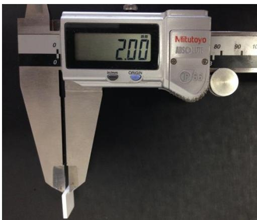
Figura 1. Espessura de uma amostra cerâmica após regularização.
