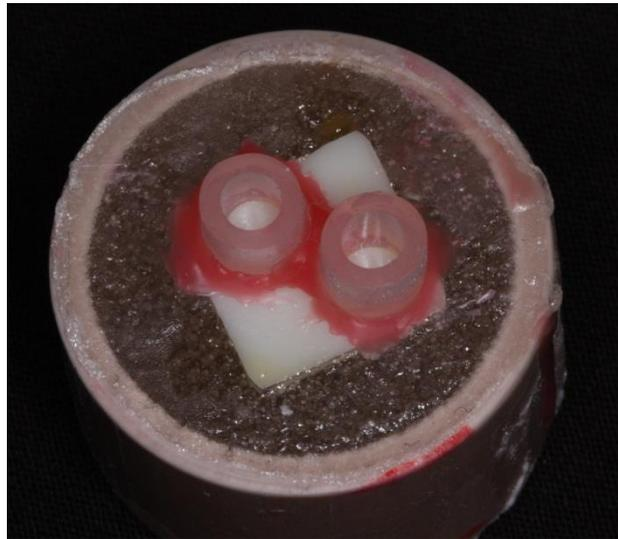
Figura 10. Matrizes transparentes fixadas sobre uma amostra.
