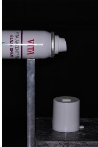
Figura 5. Dispositivo adaptado para vitrificação da amostra cerâmica.
