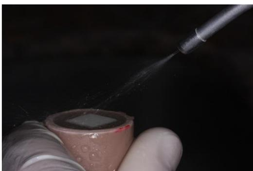
Figura 8. Lavagem da amostra condicionada com HF.
