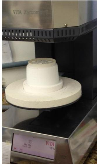
Figura 2. Amostras posicionada no forno antes da sinterização.
