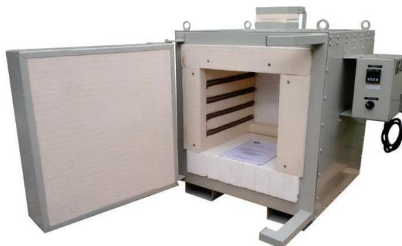
Figura 13 – Imagem ilustrativa de um forno mufla)
