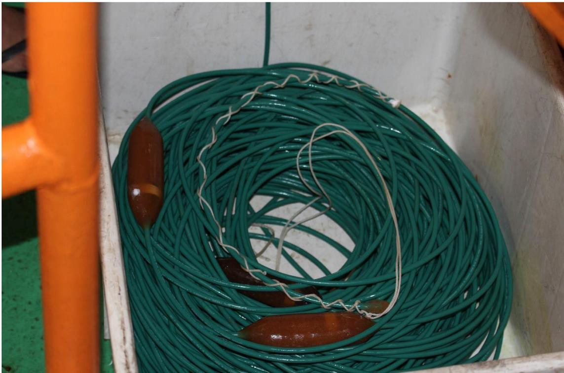
Fig. 4. Matriz de arrasto de 250 m composta por três hidrofone, sendo um funcional.
