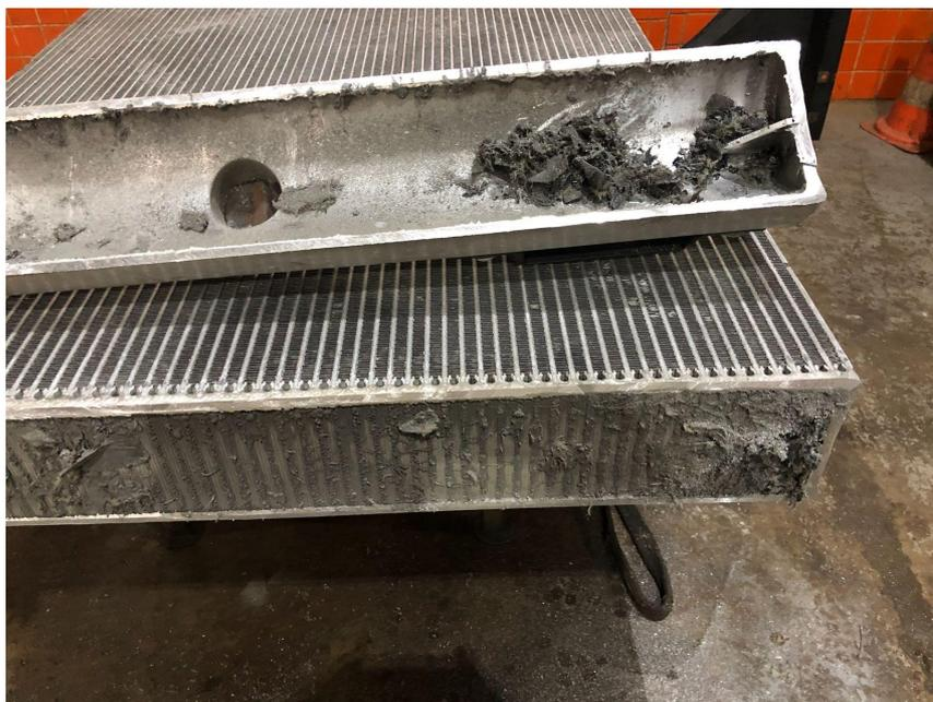
Figura 35 – Imagens de verificação de radiador após falha na escavadeira em estudo (fonte: U&M Mineração e Construção)
