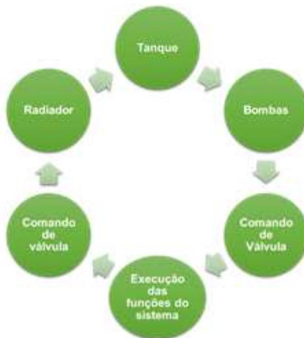
Figura 29 – Diagrama funcional do sistema hidráulico (fonte: autora)
