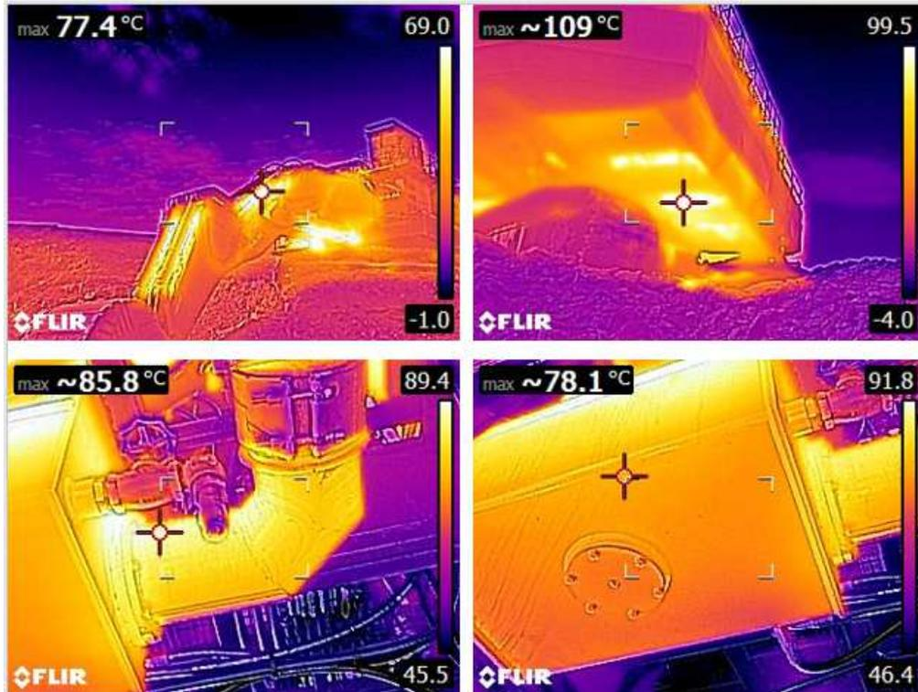
Figura 39 – Imagem termográfica do equipamento em geral e do tanque hidráulico (fonte: U&M Mineração e Construção)
