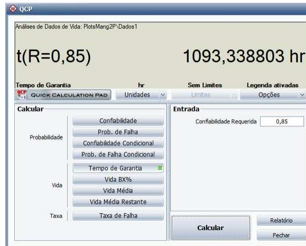
Figura 48 – Cálculo de PF usando o software Reliasoft para Mangueiras/Mangotes (fonte: Reliasoft Weibull++)
