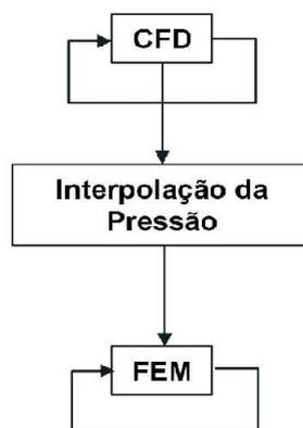
Figura 5 – Processo de acoplamento unidirecional.
