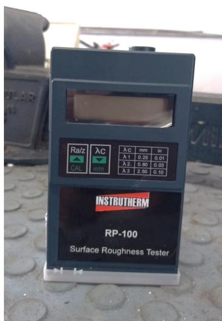
Figura 15 - Rugosímetro utilizado nos experimentos. Fonte: Próprio Autor.
