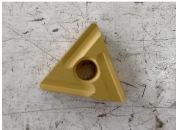
Figura 14 - Ferramenta de corte utilizada nos experimentos. Fonte: Próprio autor.
