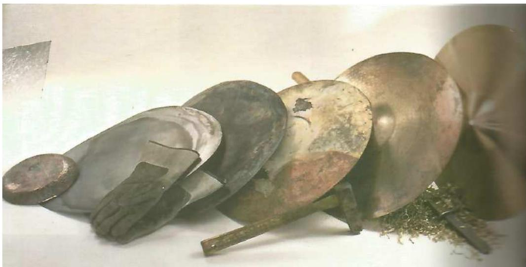
Figura 5 – Etapas de um prato B20. Da esquerda para a direita: a) Lingote. b) Laminado. c) Estampado com cúpula. d) Temperado. e) Martelado. f) Usinado.
