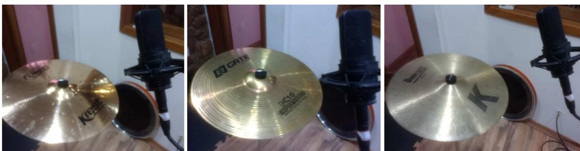
Figura 16 – Foto dos pratos utilizados no ensaio. a) B8. b) B10. c) B20.
