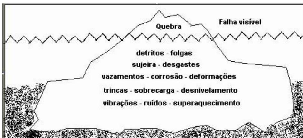
**Figura 6 - Iceberg representando causas invisíveis gerando uma falha visível**
