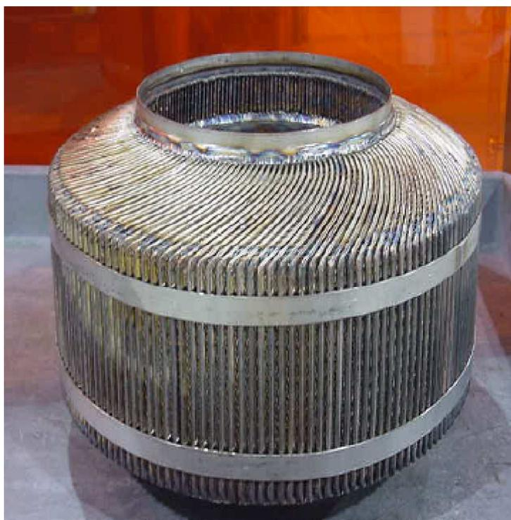
Figura 15 – Recuperador anular tipo CWPS das microturbinas Capstone C30 e C65. Fonte: (CAPSTONE, 2008)
