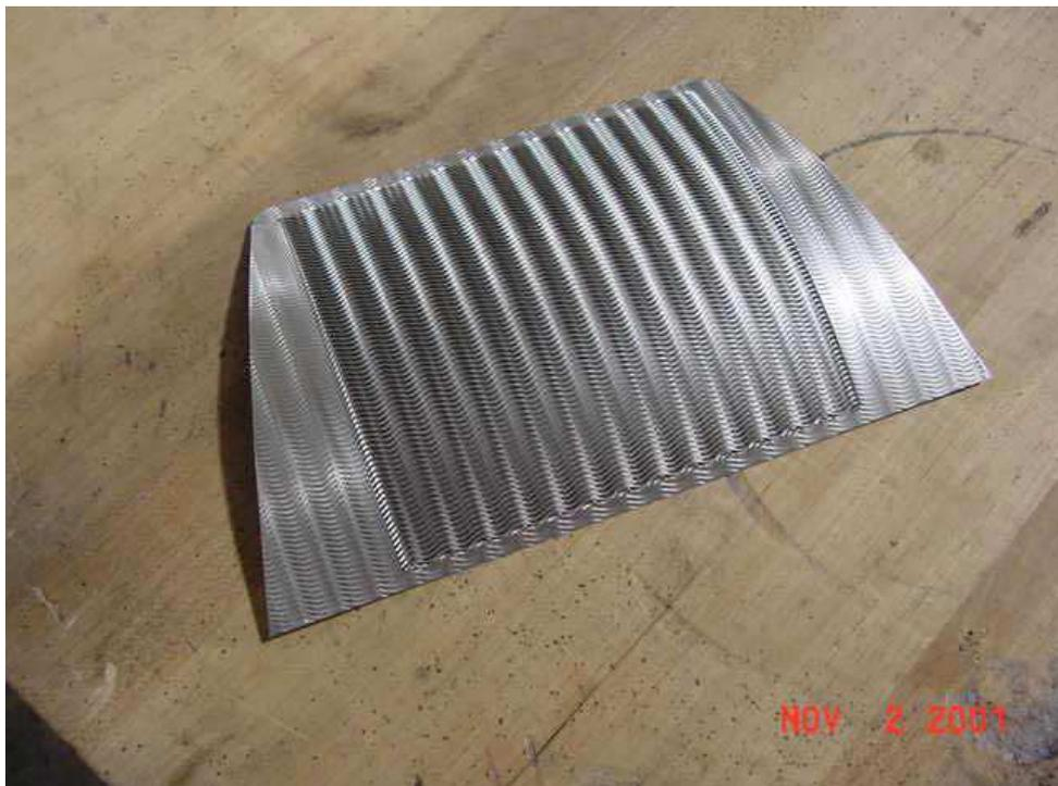
Figura 17 – Folha individual do recuperador, após o processo de estampagem. Fonte: Treece, Vessa e McKeirnan (2002).
