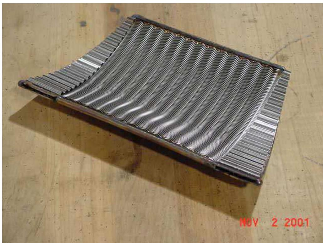
Figura 18 – Célula de ar ou segmento do núcleo do recuperador após montagem. Fonte: Treece, Vessa e McKeirnan (2002)
