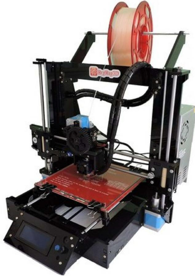
Figura 2 – Impressora RepRap 3D, modelo prusa i3. Fonte: RepRap3D.
