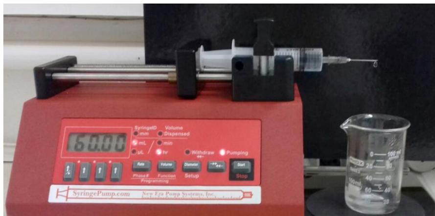
Figura 2 - Preparo da solução de Tripolifosfato de Sódio (TPP - 2,4 mg/mL), e gotejamento com bomba de infusão (60 mL/h)
