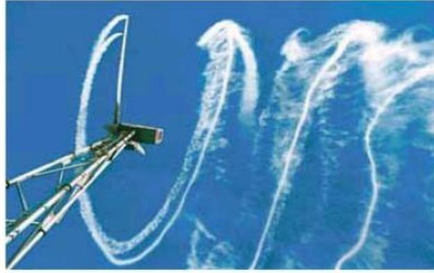
**Figura 2.5 - Efeito de sombreamento observado em um aerogerador (LEITE, 2005).**
