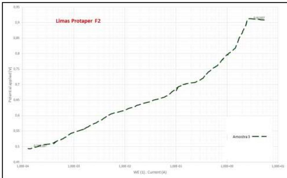
Gráfico 3 – Curva de polarização anódica em solução de NaOCl a 5,25% naturalmente aerada para a lima ProTaper® Universal (Amostra 3).
