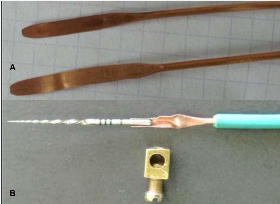
Figura 6 – Fotografias dos eletrodos de trabalho: A) fio de cobre laminado em uma de suas pontas até a espessura de 1 mm; B) dispositivo projetado para a fixação do contato metálico lima/fio de cobre.
