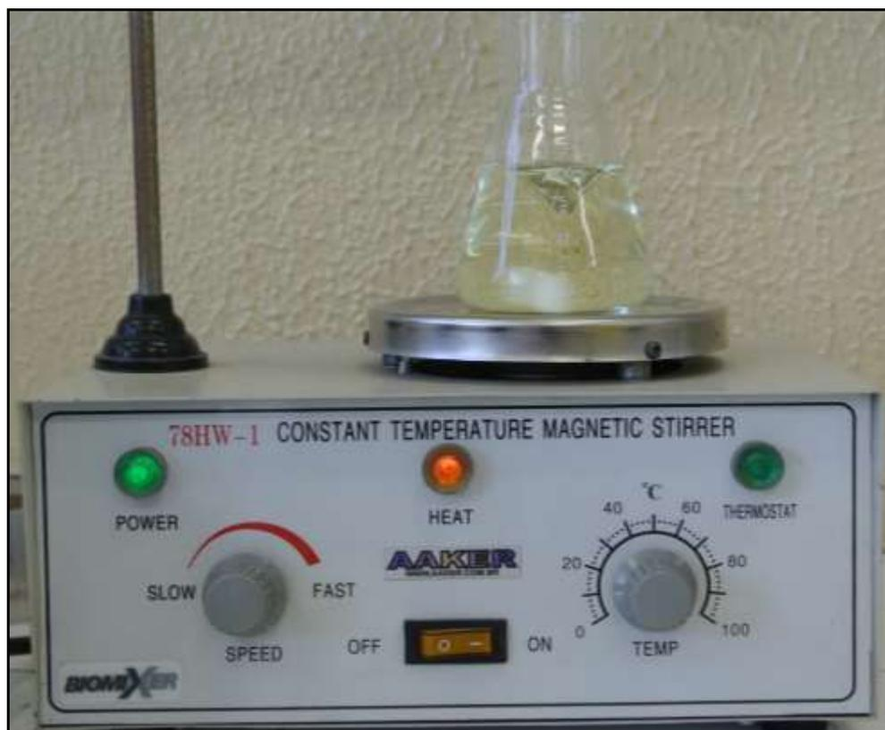
Figura 3 – Fotografia do estabilizador de temperatura (Biomixer) no momento da obtenção de 37°C da solução de NaOCl a 5,25%.
