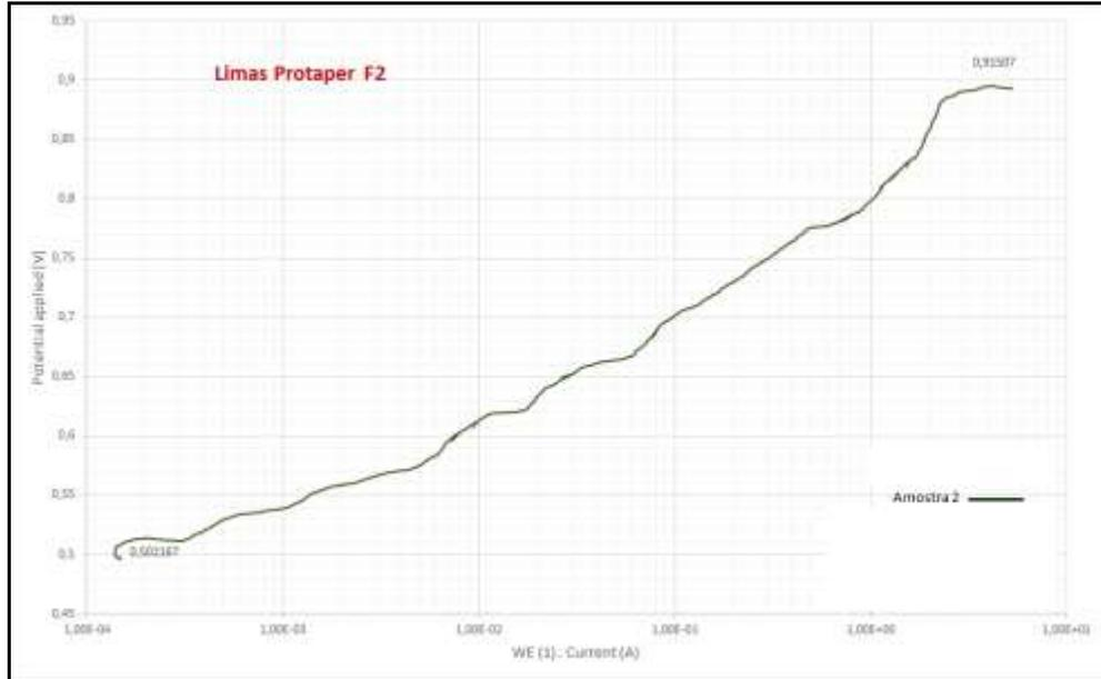
Gráfico 2 – Curva de polarização anódica em solução de NaOCl a 5,25% naturalmente aerada para a lima ProTaper® Universal (Amostra 2).
