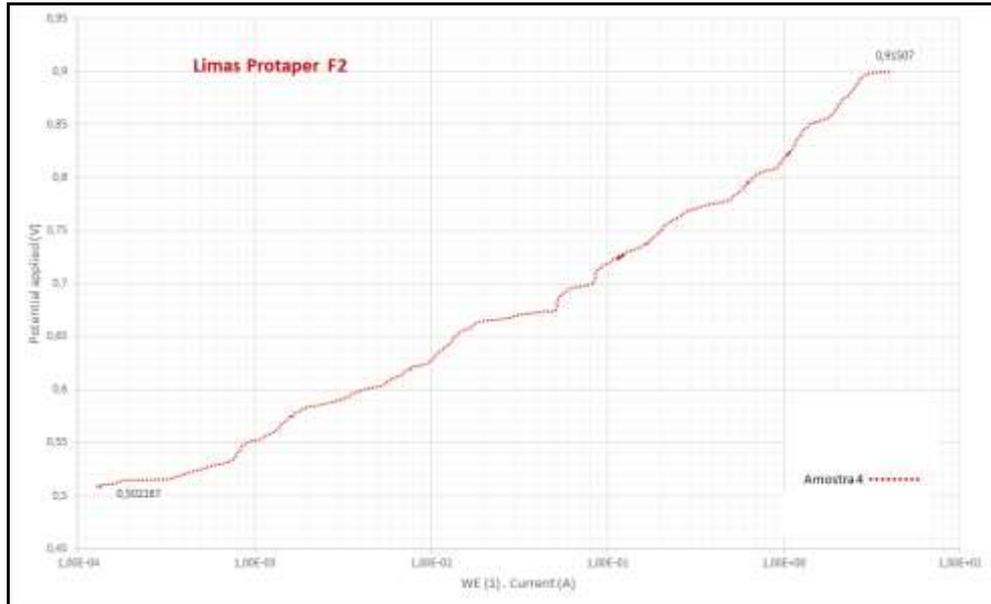
Gráfico 4 – Curva de polarização anódica em solução de NaOCl a 5,25% naturalmente aerada para a lima ProTaper® Universal (Amostra 4).
