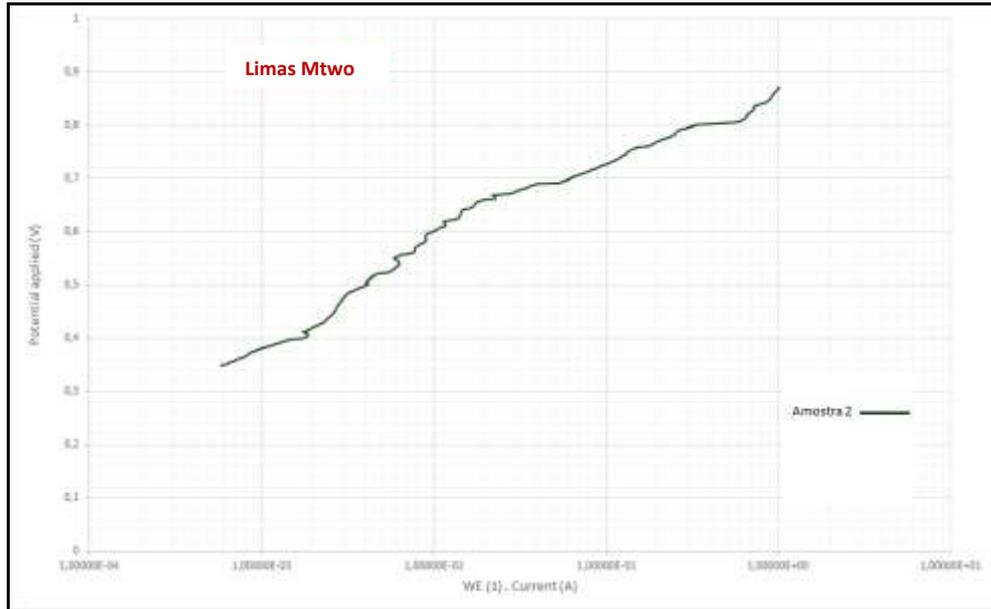
Gráfico 10 – Curva de polarização anódica em solução de NaOCl a 5,25% naturalmente aerada para a lima Mtwo® (Amostra 2).
