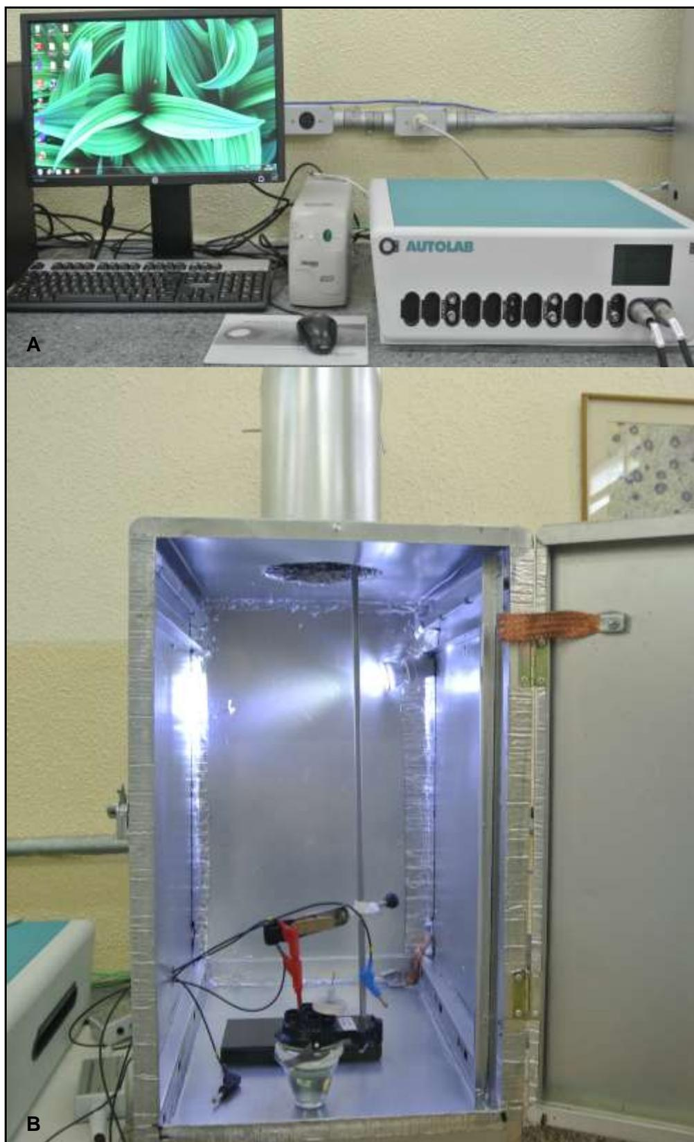
Figura 4 – Fotografias do potenciostato PGSTAT 128N (Metrohm Autolab®): A) potenciostato acoplado ao computador com o *Advanced Electrochemical Software* NOVA 1.9; B) gaiola de *Faraday* (onde o experimento é realizado; evita interferências e possibilita um resultado mais fidedigno); célula contendo a solução de NaOCl, o eletrodo calomelano (referência), eletrodo de trabalho (lima a ser testada) e o eletrodo de platina (libera a corrente).
