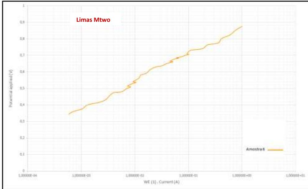
Gráfico 14 – Curva de polarização anódica em solução de NaOCl a 5,25% naturalmente aerada para a lima Mtwo® (Amostra 6).
