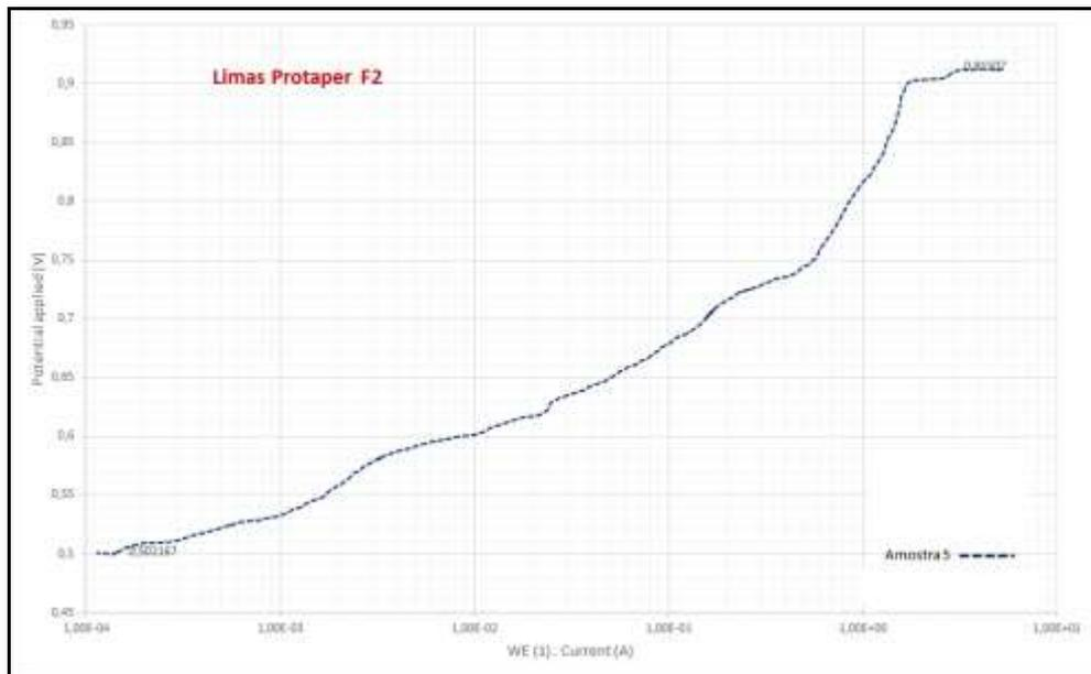
Gráfico 5 – Curva de polarização anódica em solução de NaOCl a 5,25% naturalmente aerada para a lima ProTaper® Universal (Amostra 5).
