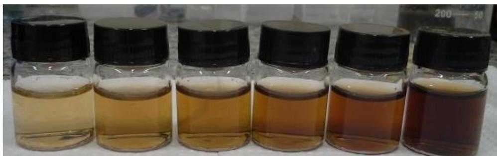
Figura 30: Dispersões aquosas de óxido de grafeno obtidas após o processo de ultrasonicação em um ultrassom de ponta. Da esquerda para direita, concentrações de 0.1 a 0.5 mg/ml e 1 mg/ml, respectivamente.
