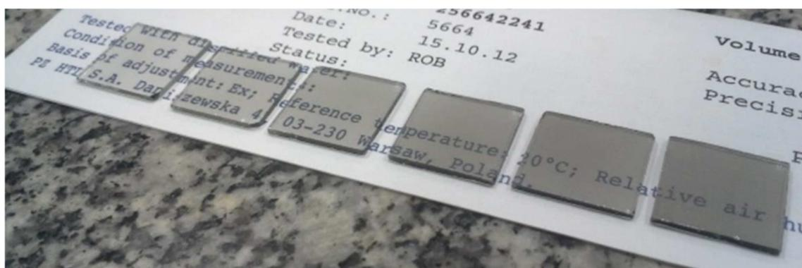
Figura 32: Sequência de filmes de r-GO após o processo de redução química usando hidrazina hidratada durante 24 h. Da esquerda para direita são apresentados filmes com 5 s, 10 s, 15 s, 20 s, 25 s e 30 s de exposição, respectivamente.
