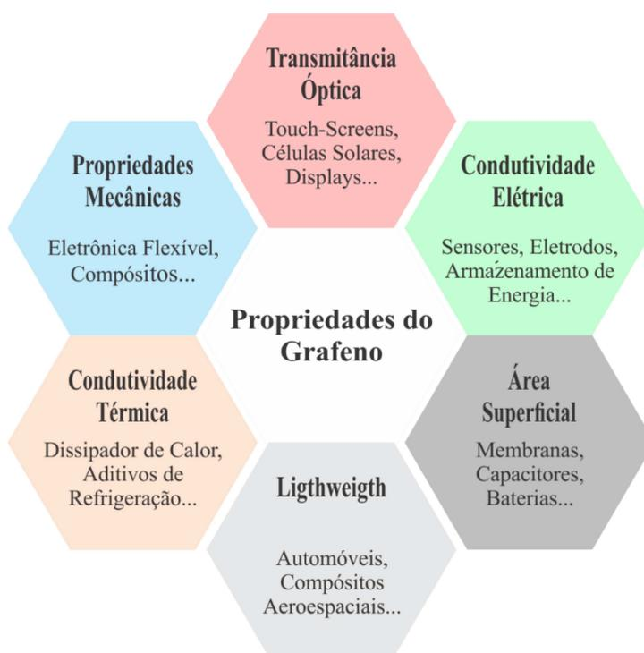
Figura 1: Esquema mostrando algumas propriedades físicas do grafeno e uma seleção de potenciais aplicações deste material. Figura retirada e adaptada de Smith *et al.*<sup>7</sup>.
