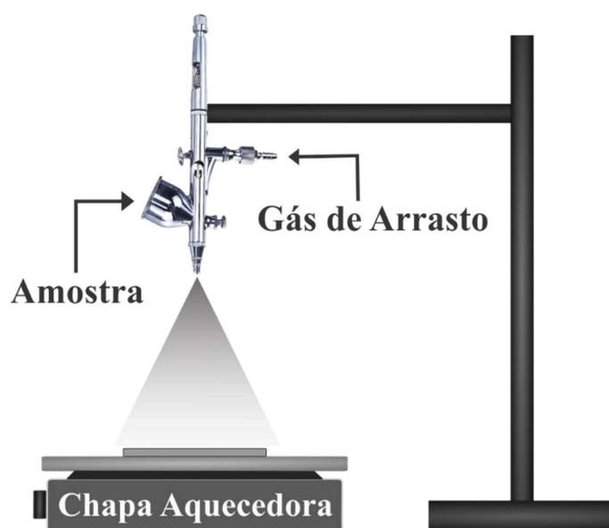
Figura 31: Representação esquemática de um sistema de deposição por *sprayer* usado para preparar os filmes finos de GO.
