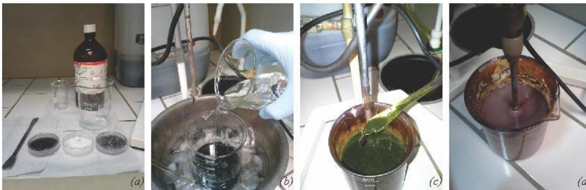
Figura 27: Imagens (a)  $\text{H}_2\text{SO}_4$ ,  $\text{KMnO}_4$ ,  $\text{NaNO}_3$  e do grafite em flocos usados como material de partida; (b) banho de gelo feito durante a mistura dos reagentes; (c) meio reacional após 24 h de reação e (d) após 120 h de agitação constante em temperatura ambiente.
