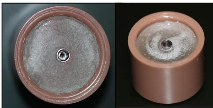
Figura 6: Análogo do implante incluído no interior do tubo de PVC.
