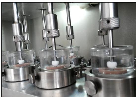
Figura 21: Simulador de fadiga mecânica.
