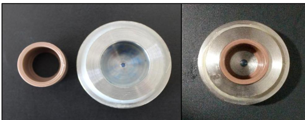
Figura 3: Tubo de PVC e base pré-fabricada (metálica) para padronização do posicionamento.
