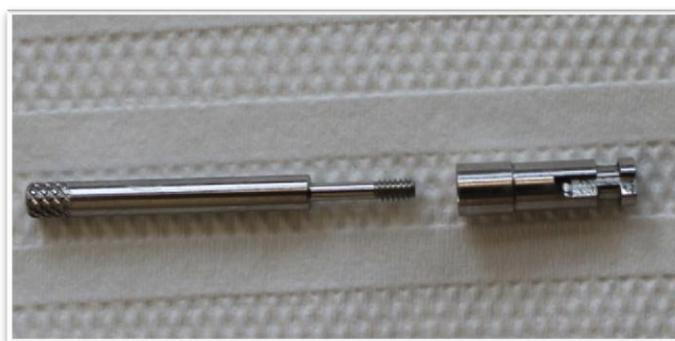
Figura 4: Parafuso *Washing Screw* e réplica do implante cone morse.
