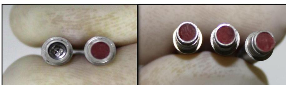
Figura 11: Interior das bases metálicas preenchidas com cera utilidade.
