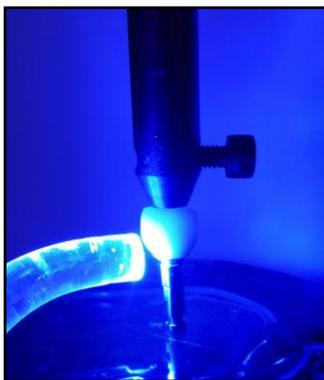
Figura 15: Fotopolimerização do cimento Relyx U200, sob carga constante de 5Kg por 10 minutos.
