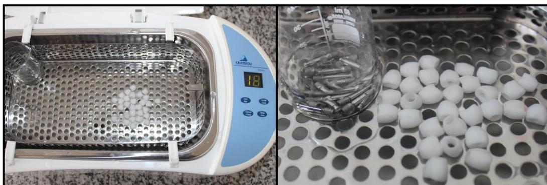
Figura 10: Cuba ultrassônica utilizada no processo de limpeza das peças de zircônia e das bases metálicas.
