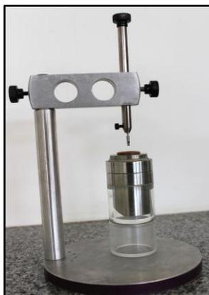
Figura 2: Delineador utilizado para posicionar os análogos no interior do tubo de PVC.
