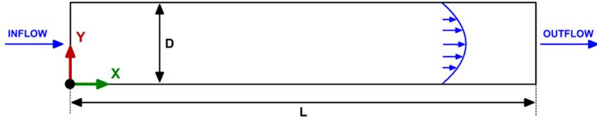
Figura 2.5: Ilustração do escoamento de Poiseuille em Regime Laminar
