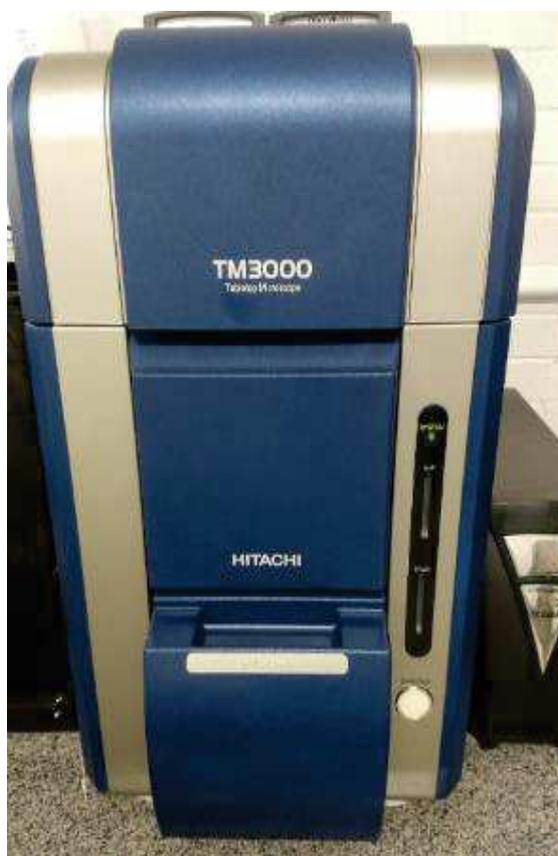
Figura 7 – Microscópio eletrônico de varredura de bancada. TM 3000 – Hitachi
