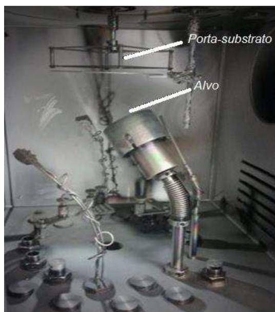
**Figura 30.** Câmara de vácuo mostrada internamente.
