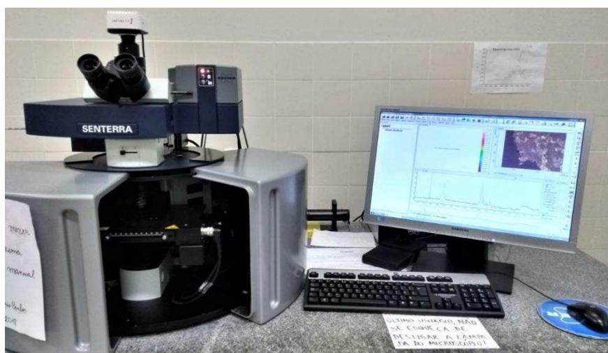
**Figura 39.** Espectrofotômetro Raman fabricado pela BRUKER do laboratório de Núcleo de Espectroscopia e Estrutura Molecular da UFJF-MG .
