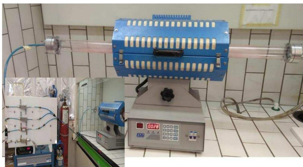
**Figura 31.** Forno elétrico da EDG equipamentos, modelo FT-HI/40.
