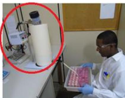
Figura 25: Agitação do leite no barrilete durante o processo de amostragem.
