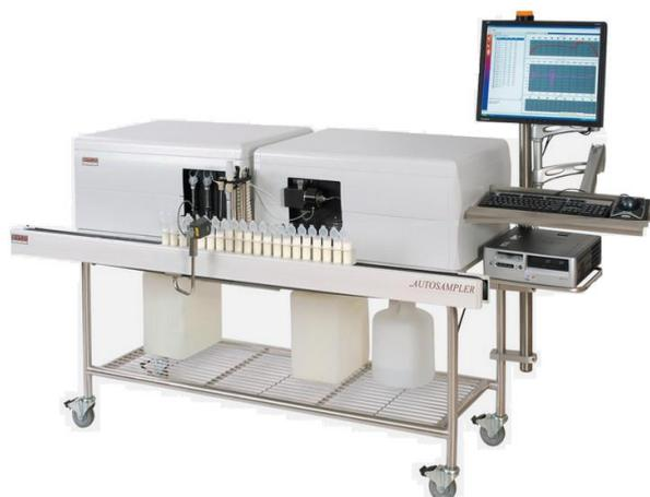
Figura 34: Equipamento marca Bentley Instruments NexGen modelo Somacount FCM Bentley FTS (Nexgen) (Fonte: Bentley Instruments, 2015a).
