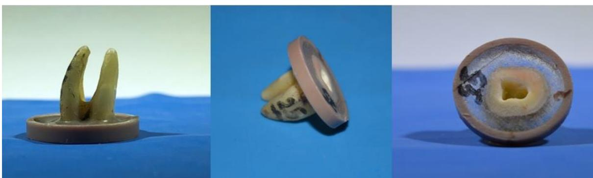
Figura 2: Fixação do dente a um anel com resina epóxi na região amelocementária.
