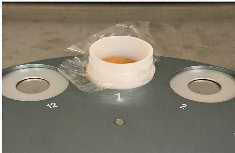
**Figura 13:** Porta – Amostra no espectrômetro de raios-X por dispersão em energia.
