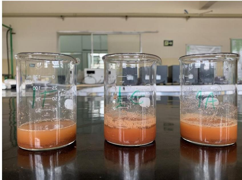
**Figura 12:** Suspensão das amostras de solo em solução de KCl.
