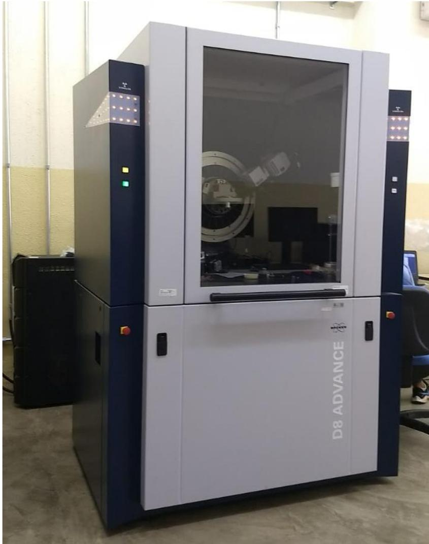
**Figura 15:** Difractometro da marca Bruker , utilizado no ensaio.
