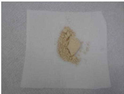
Figura 24 - Extrato de Guaco + maltodextrina 8% após procedimento com Buchi Mini Spray Dryer B-191
