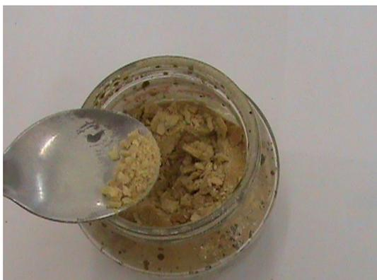
Figura 21 - Extrato liofilizado com maltodextrina como adjuvante
