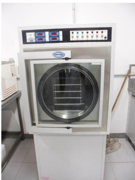
Figura 10 - Liofilizador de Bandeja Terroni Fauvel LHO 400/4L
