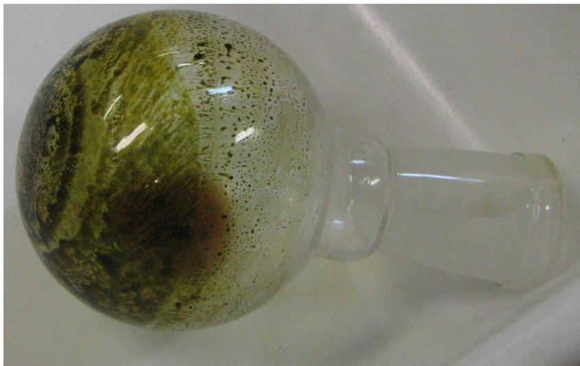
Figura 18 - Resíduo de Extrato de Guaco hidroalcoólico rotaevaporado
