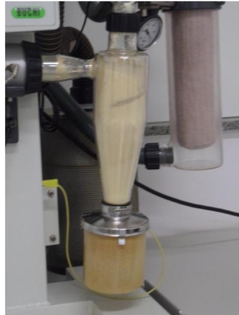
Figura 14 e Figura 15 - Equipamento spray dryer Modelo Buchi Mini Spray Dryer B-191
