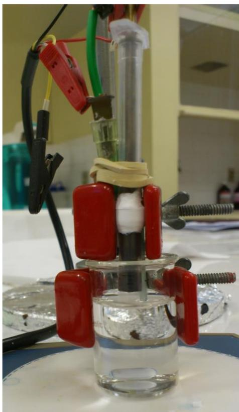
**FIGURA 9:** Célula eletroquímica constituída de três eletrodos.
