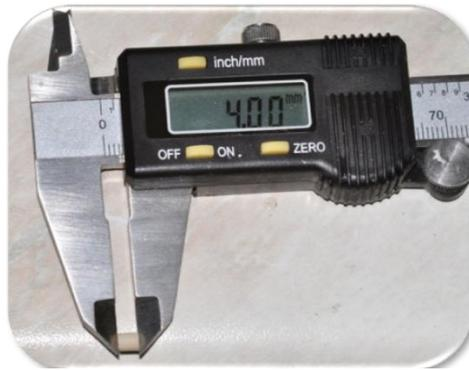
Figura 23 - Paquímetro digital (Mitutoyo, Japão).
