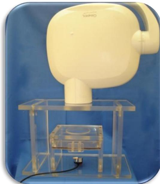
Foi utilizado o sistema de radiografia digital direta Visualix e HD (Gendex, EUA). Sobre o sensor foram colocados: um corpo de prova de cada grupo (Figura-25), o corte do dente com a espessura correspondente a 1 mm (Figura-26) e uma escala de densidade de alumínio com espessuras variando de 1 mm a 11 mm, com incrementos de 1mm (Figura-27). Os corpos de prova foram colocados sobre o sensor seguindo sempre na mesma ordem.
