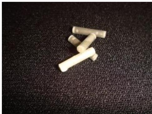
Figura 36 - Corpos de prova (tubos) do teste de liberação de íons cálcio
