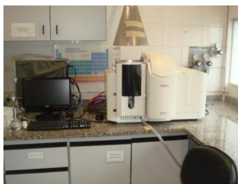
Figura 40 - Espectrofotômetro de absorção atômica equipado com uma lâmpada de cátodo específico para o cálcio.
