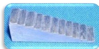
Figura 27 - escala de densidade de alumínio com espessuras variando de 1 mm a 11 mm, sobre o sensor
