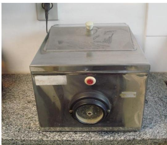
Figura 6 - Estufa com temperatura e umidade controladas,  $37^{\circ}\text{C} \pm 1^{\circ}\text{C}$  e  $95\% \pm 5\%$ , respectivamente
