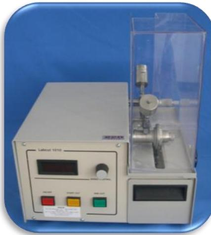
Figura 21 - Cortador de tecidos duros (Labcut 1010, Excet Corp. EUA).
