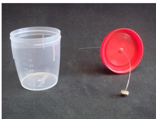
Figura 14 - Desmembramento do conjunto, frasco, tampa e corpo de prova
