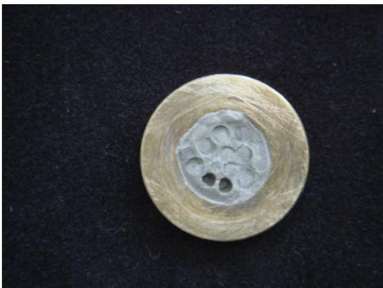
Figura 12 – Marcas iniciais e finais no corpo de prova após a presa final (cimento com presa tomada)
