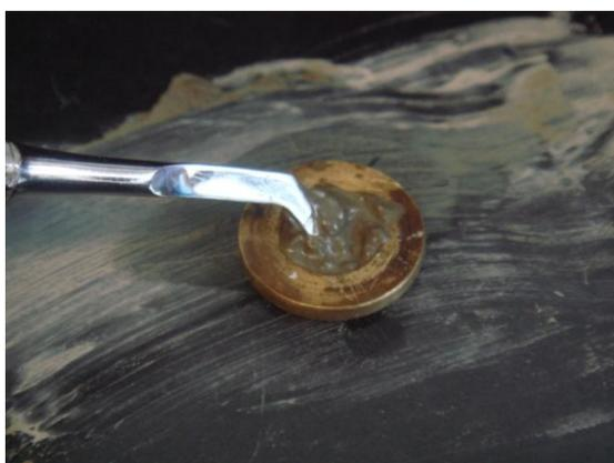
Figura 8 - Cimento espatulado e vertido no anel metálico
