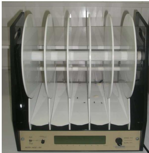
**FIGURA 2:** Aparelho do teste da barra giratória (modelo LE 8200, empresa Panlab s.l.) para observação de coordenação motora. Fonte: Vinícius de Almeida Vieira.
