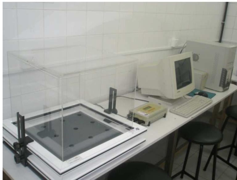
**FIGURA 5:** Aparelho para teste da placa perfurada (modelo LE 8811 da empresa Panlab s.l.). Fonte: Vinícius de Almeida Vieira.
