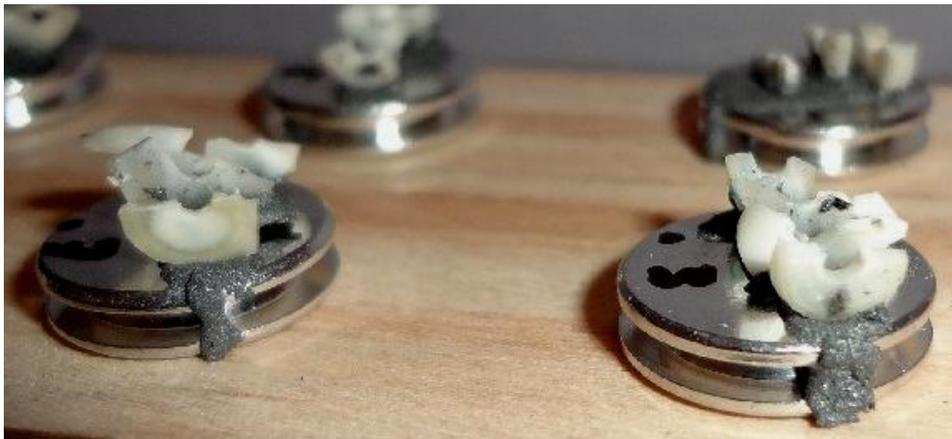
**Figura 6:** Fixação dos corpos de prova nos *stubs*.
