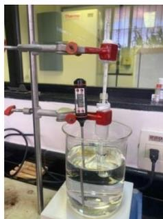
Figura 8. Aparato montado para determinação do ponto de gota do bálsamo labial.
