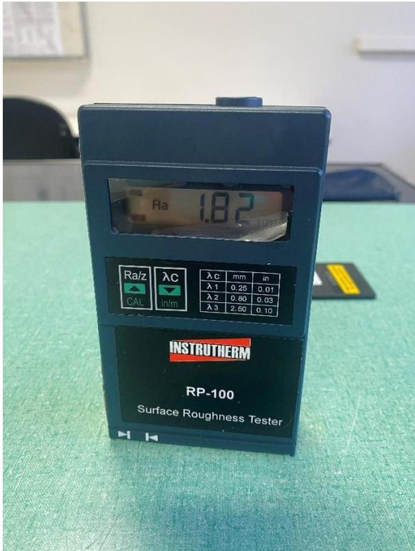
Figura 4. Avaliação da rugosidade superficial das resinas acrílicas testadas. Espécime em disco com 10 mm de diâmetro por 1 mm de espessura sendo submetido ao teste de rugosidade utilizando-se um rugosímetro para registrar as variações de sua textura superficial (2 leituras).
