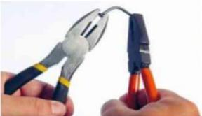
>4<sup>o</sup> Agora, enrolem um dos pregos com o fio de cobre e o outro, com a tira de zinco. Utilizem um alicate para enrolar a fita de zinco e o fio de cobre, tendo o cuidado de mantê-los em contato bem justo aos pregos [figura 5.60].
