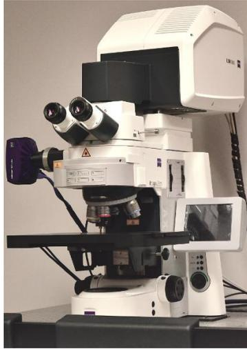
Figura 31 - Microscópio Confocal de Varredura a Laser Zeiss LSM800
