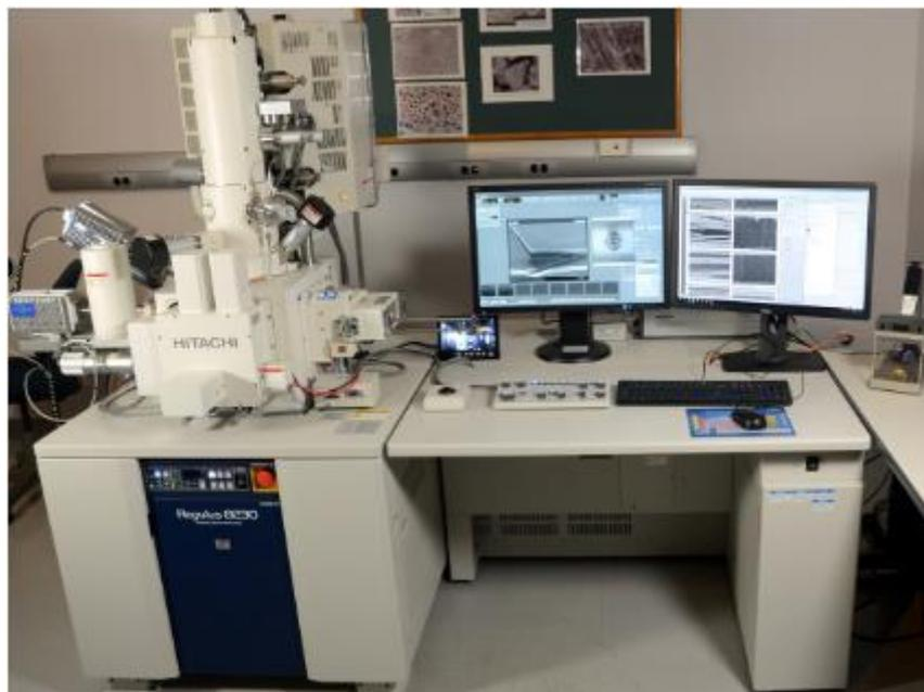
Figura 25 – Microscópio eletrônico de varredura (Hitachi SU8230, Tóquio, Japão), acoplado a um espectrômetro de energia dispersiva de raios X (Bruker X-Flash FQ5060, Alemanha)
