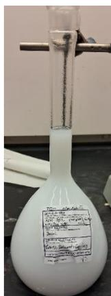
Figura 14 – Aspecto do balão volumétrico após a dissolução dos compostos químicos da solução eletrolítica
