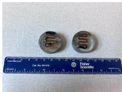
Figura 28 – Seções transversais montadas em resina epóxi
