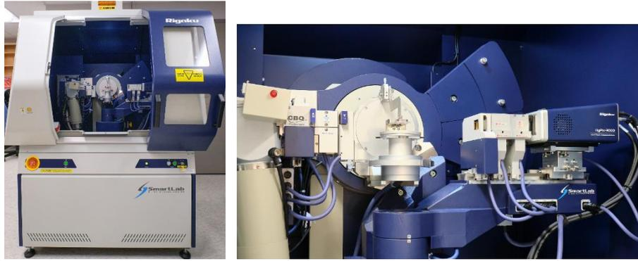
Figura 30 – Difratorômetro de raios X (Rigaku SmartLab)
