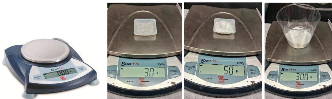
Figura 13 – Balança SCOUT™ PRO, pesagem do hidróxido de potássio (3 g/L), fosfato dissódico (5 g/L) e acetato de cálcio hidratado (30 g/L)
