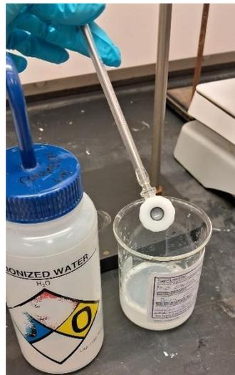
Figura 23 – Aspecto da amostra de titânio logo após o tratamento de superfície e limpeza com água destilada
