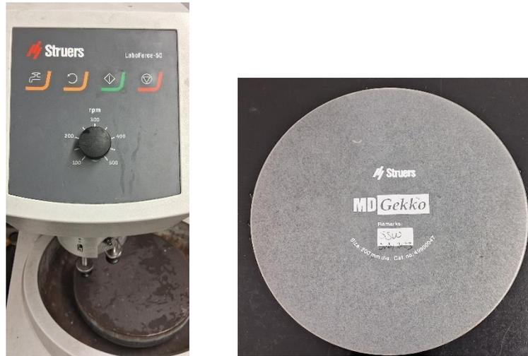
Figura 5 – Máquina LaboForce-50 (Struers S.A.S, França) e disco acoplador MD Gekko (Struers S.A.S., França)
