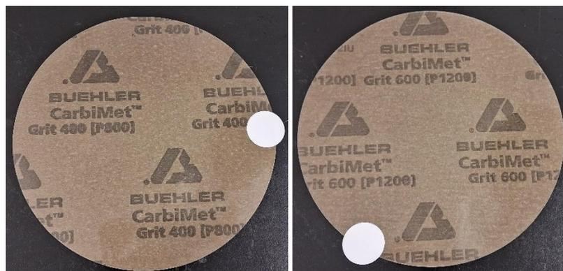
Figura 6 – Discos de lixa d'água de granulação 400 e 600 (Buehler CarbiMet™)
