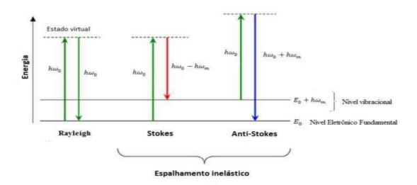
Figura 20 - Demonstração do esquema geral dos possíveis processos de espalhamento.
