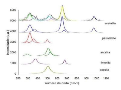
Figura 46 – imagem comparativa entre os espectros do meteorito Zagami e minerais puros.
