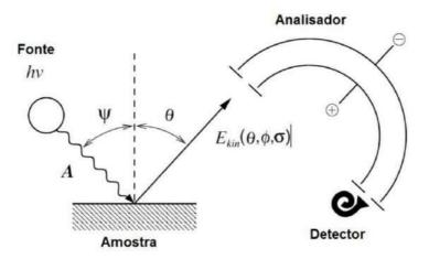
Figura 26 – Representação da realização do experimento, a partir da excitação do elétron pelo fóton, depois o caminho do fotoelétron pelo analisador até ser detectado.
