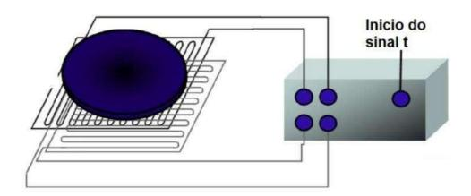
Figura 25 – Esquema do detector DLD retirado do manual SPECS Delay Line Detector.
