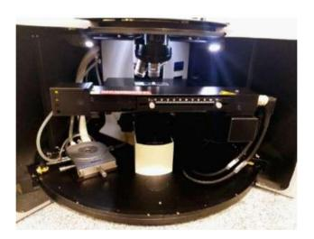
Figura 29 – Microscópio acoplado ao espectrômetro Raman
