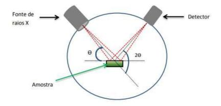
Figura 27 – Representação ilustrativa de um difratômetro.
