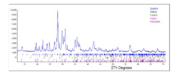
Figura 35 – Comparativo do difratograma obtido do meteorito marciano Zagami. Legenda: os dados comparativos de minerais detectados são representados por diferentes linhas (linha azul para quartzo, linha preta para olivina, linha verde para fayalita, linha rosa para augita, linha roxa para ferrosilita).
