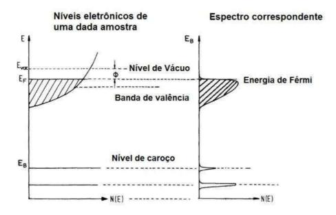
Figura 13 – Níveis eletrônicos a partir do núcleo até o nível de vácuo, passando pelo nível de Fermi (esquerda) e o correspondente espectro de XPS (direita).
