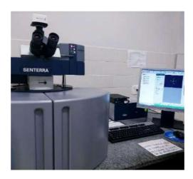
Figura 28- A Fotografia do equipamento do Raman Confocal Bruker Senterra na UFJF.
