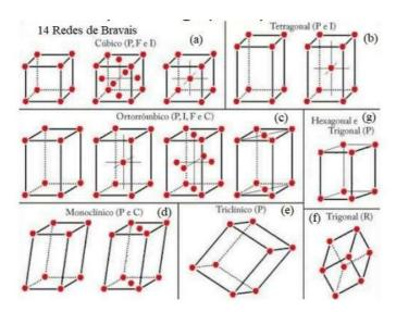
Figura 19 – As 14 redes de Bravais encontradas na natureza que formam sete sistemas cristalinos: a) cúbica b) tetragonal c) ortorrômbico d) monoclínico e) triclínico f) trigonal g) hexagonal. FONTE: ASHCROFT (1976).
