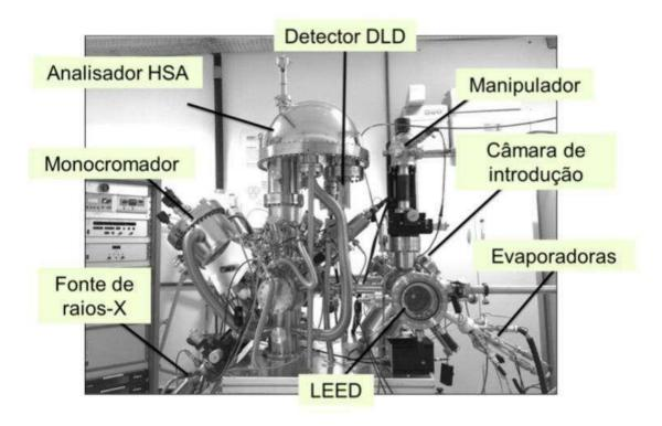
Figura 23– A Fotografia do equipamento da SPECS no laboratório do CBPF. Legenda: À esquerda, câmara de análise com fonte, monocromador, analisador e detector.
