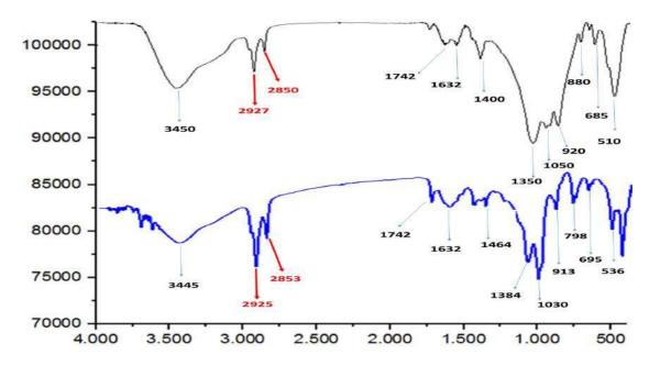
Figura 59 – Comparativo entre os espectros de IR por transmissão no meteorito Zagami.
