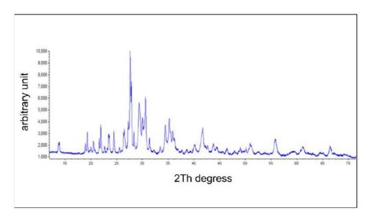
Figura 34 – Difratograma obtido do meteorito marciano Zagami
