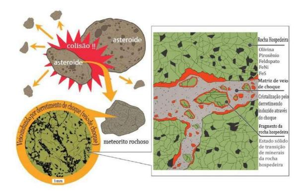
Figura 69 - Desenho esquemático do mecanismo de formação de minerais de alta pressão em veios de fusão induzidas pelo choque (veios de choque) em meteoritos. Legenda: Os minerais de alta pressão formam-se através de dois tipos de mecanismos de formação: Transformação de alta pressão em estado sólido dos minerais de rocha hospedeira e cristalização do derretimento condrítico ou monomineral sob alta pressão na matriz de choque de veio
