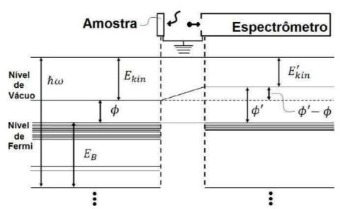
Figura 12 – Ilustração da amostra com o espectrômetro e suas implicações eletrônicas.
