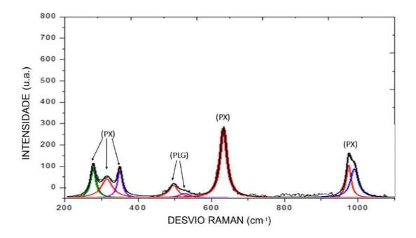
Figura 54 – Espectro de identificação dos minerais Piroxênios e Plagioclásio. Legenda: Os minerais Augita e Piogenite estão simbolizados por PX (Piroxênio) e a PLG (Plagioclásio).
