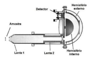
Figura 24 – HSA - Partindo da amostra passando pelas lentes eletrostáticas, até a entrada da casca esférica, onde o elétron será selecionado através da trajetória até alcançar o detector.
