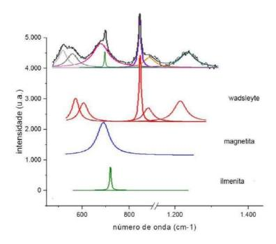
Figura 48 – Imagem comparativa entre os espectros do meteorito Zagami e minerais puros.
