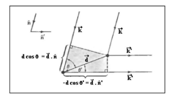
Figura 15 - Ilustração da diferença de caminho para raios espalhados a partir de dois pontos separados por uma distância "d". Fonte: Ashcroft, 1976.
