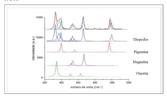
Figura 47 – Imagem comparativa entre os espectros do meteorito Zagami e minerais puros.
