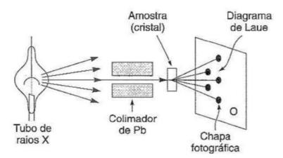
Figura 14 - Esquema pictórico do dispositivo para difração de raios X. Fonte: Nussenzveig (2013).
