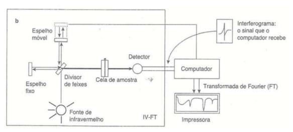
Figura 30 – Modelo representativo de um FTIR.
