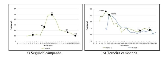
**Figura 5.12 -** Variação de turbidez mostrando as amostras utilizadas para a análise de sólidos totais. Fonte: ASSIS *et al.*, 2013.
