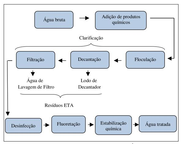
**Figura 3.1** – Fluxograma de uma Estação de Tratamento de Água Convencional. Fonte: Adaptado de PÁDUA, 2006.
