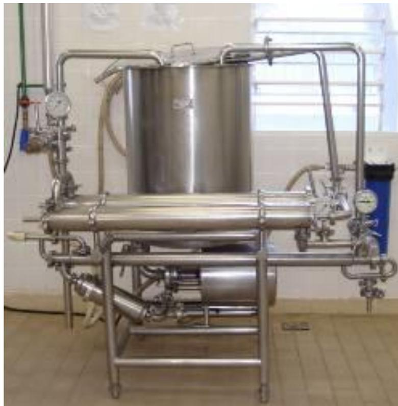
**Figura 5.** Equipamento concentrador por ultrafiltração utilizado no experimento.
