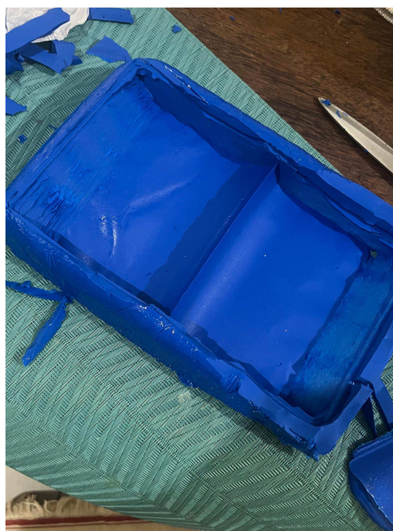
35. Fotografia do processo. Molde de silicone pronto.
