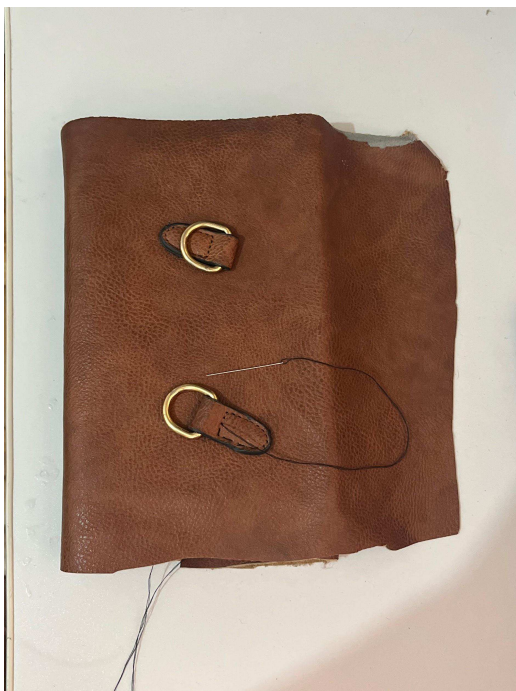
23. Fotografia do processo. Couro recortado e fivelas sendo costuradas no couro.
