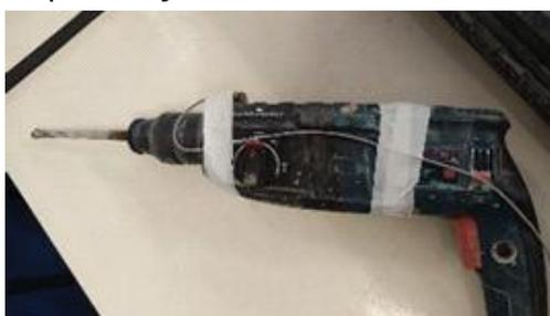
(c) Equipamento de perfuração com acelerômetro instalado
