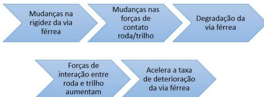
Figura 15. Processo de deterioração da via devido à diferença de rigidez. Fonte: Tzanakakis, 2013.
