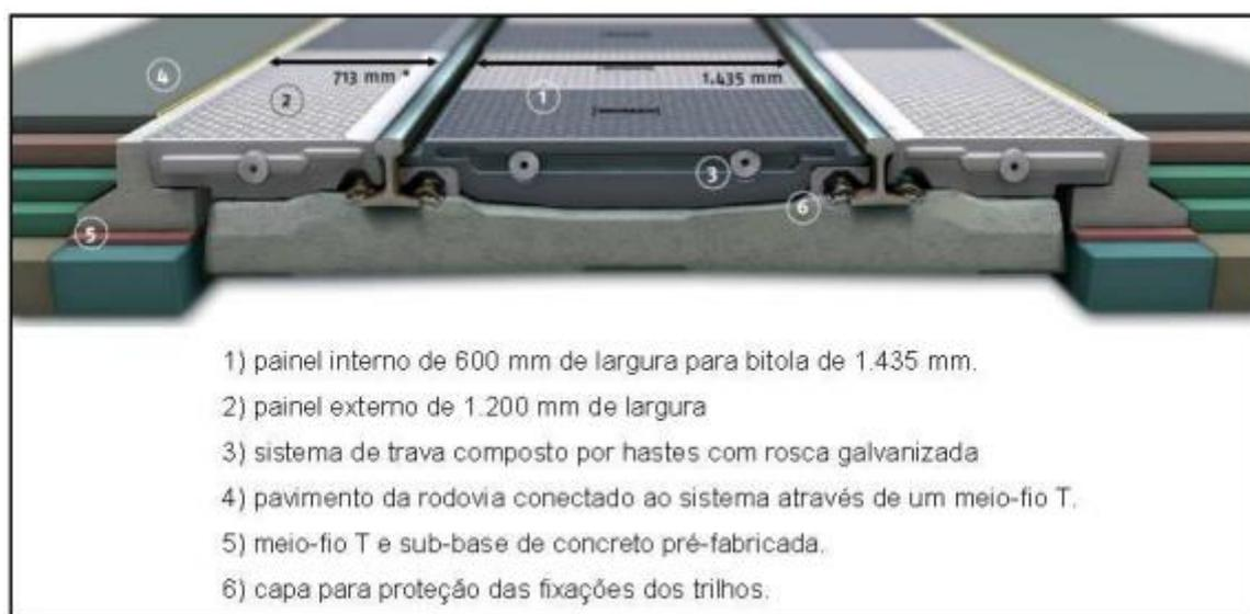
Figura 29. Elementos e esquema da aplicação das placas de borracha. Fonte: KRAIBURG, 2010a.
