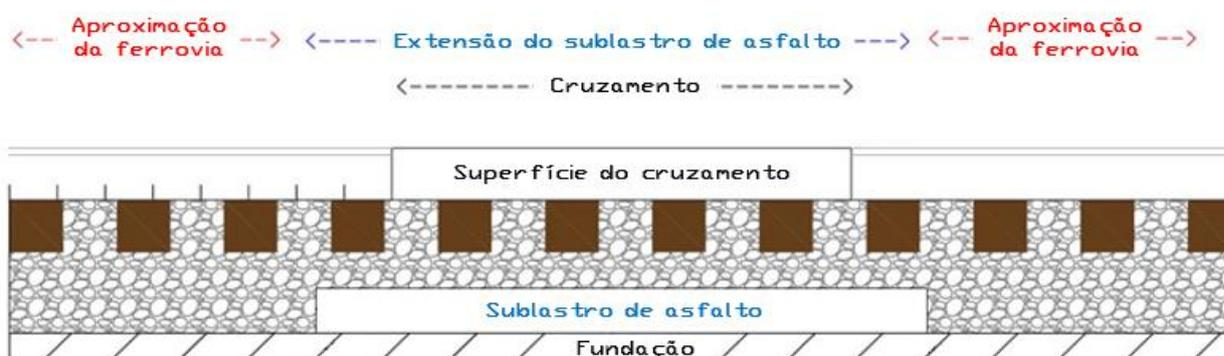
Figura 24. Corte longitudinal de passagem em nível com sublastro asfáltico. Fonte: Rose, 2016.
