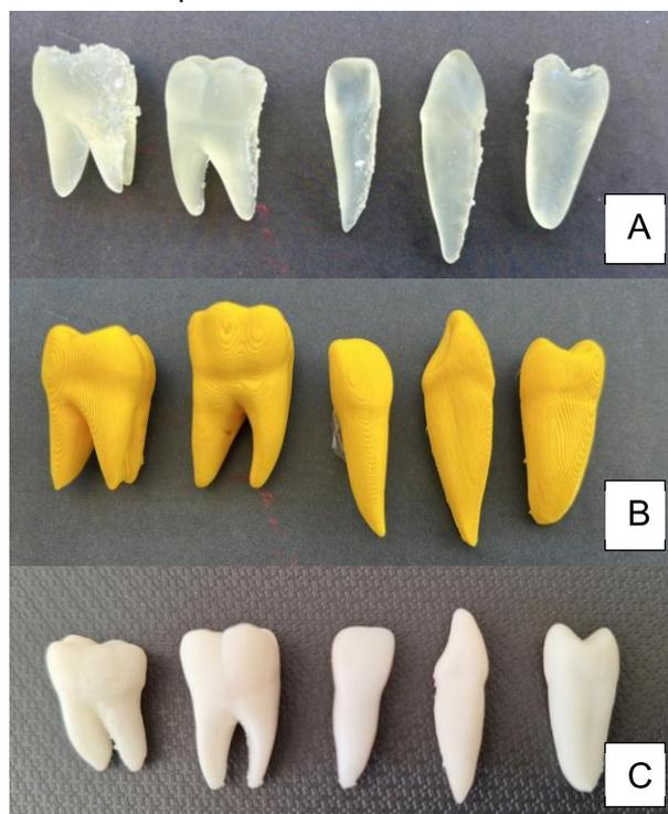
Legenda: A-Dentes confeccionados pela Impressora Elegoo Saturn B:Dentes confeccionados pela Impressora Creality com filamento PLA amarelo (1,75m m), C: Dentes confeccionados pela Impressora Anycubic photon mono 2.
