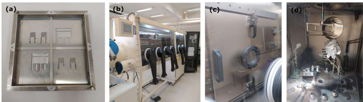
Figura 3: (a) Máscara para deposição do interdigitado de alumínio. (b) Glovebox da MBRAUN com sistema de deposição por sputtering e evaporação térmica resistiva. (c) Câmara de alto vácuo. (d) Câmara de evaporação térmica resistiva.
